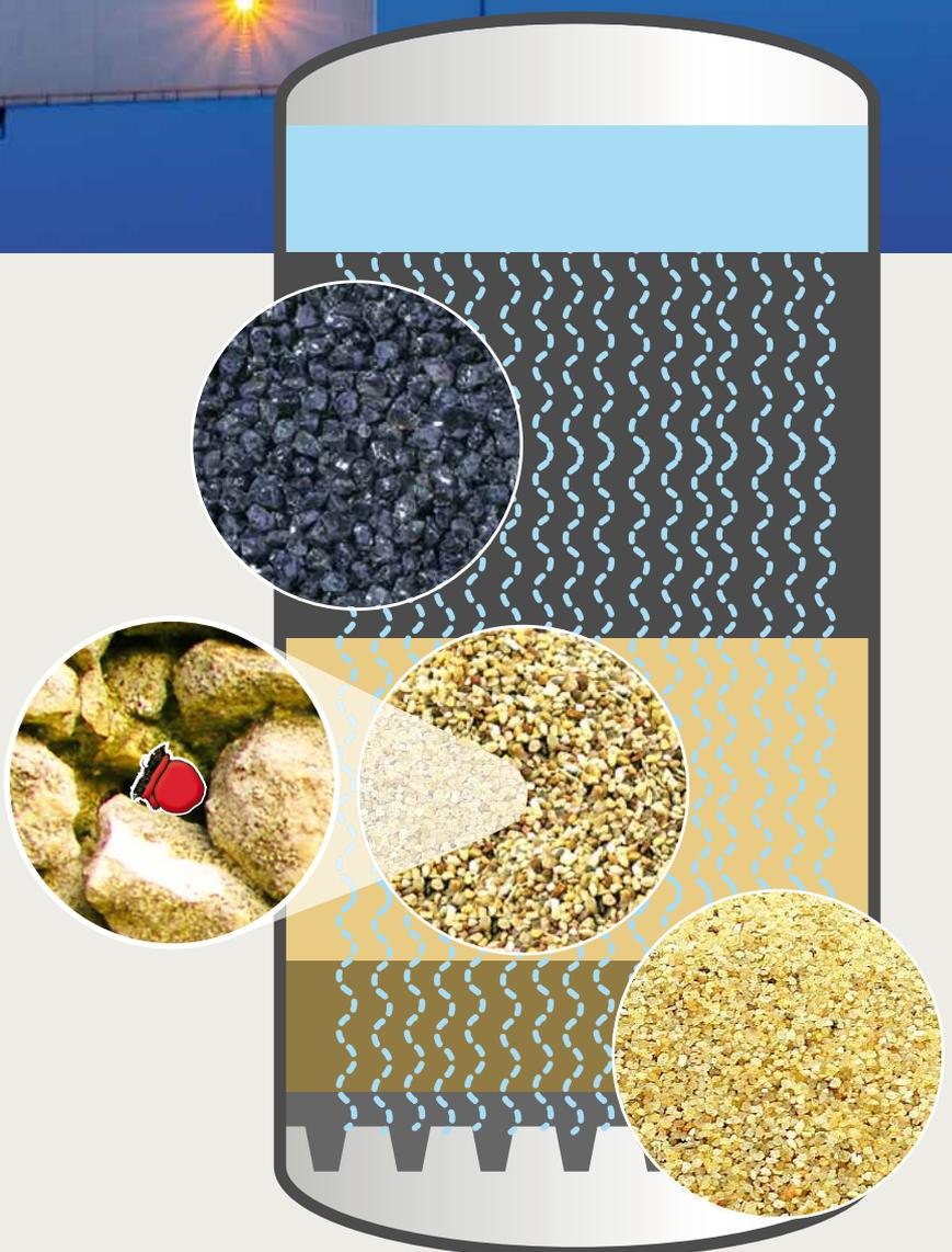
Abb. 21: Aufbau Kiesfilter
